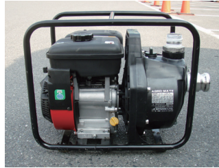
エンジンポンプ 吐出量：500～600L/min程度
