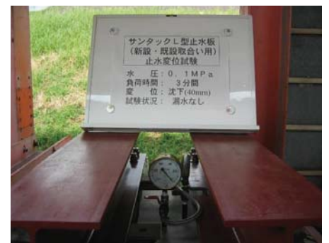
沈下量40mm/耐水圧0.1MPa
