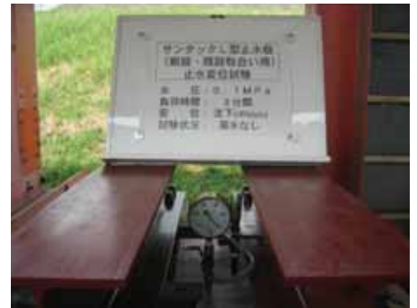
沈下量40mm/耐水圧0.1 MPa
