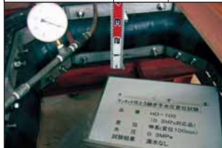
水圧試験状況 (HO-100 : 高水圧タイプ)
